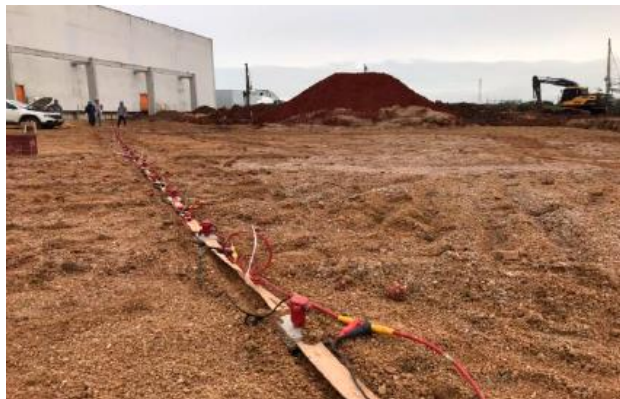
Figura 14. Execução da tomografia do solo por imagem, visualizando-se a linha de 24 geofones.
