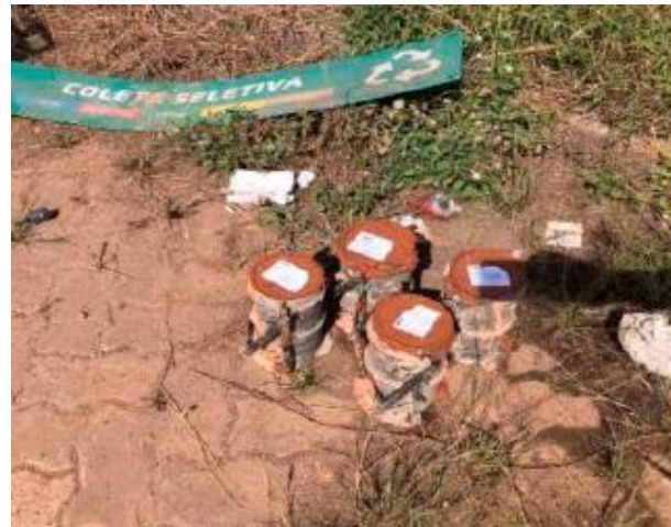
Figura 10. Moldagem dos corpos de prova
