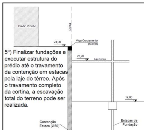
Figura 13. 5ª Etapa: Execução da superestrutura do prédio (pilares, vigas e lajes) para travamento da cortina de estacas.
